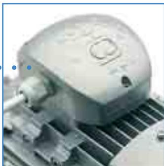
Afin de garantir une étanchéité optimale des moteurs motive, la boîte à bornes a été dotée de presse-étoupe anti-arrachement et les roulements ont été dotés d'une bague à lèvres servant à protéger les deux côtés du moteur.
