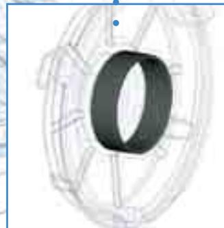
À partir du type 90, le siège des roulements a été renforcé avec un insert en acier, noyé dans chaque palier en aluminium moulé sous pression. Par ailleurs, un anneau de retenue type Seeger bloque les roulements dans leurs sièges. De cette façon, la résistance axiale et radiale augmente remarquablement tout en garantissant une longévité plus importante.
