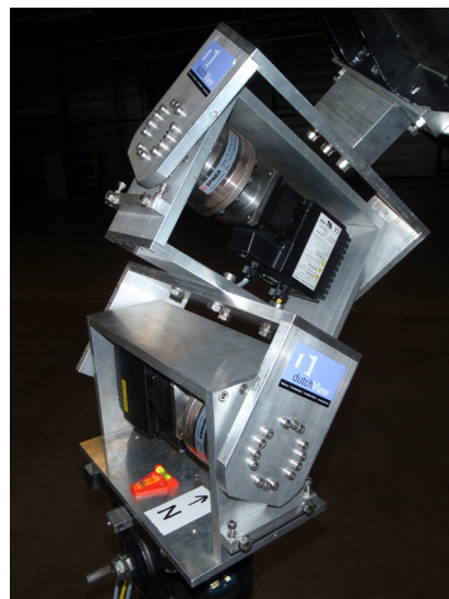
Montering af motorerne i enheden
