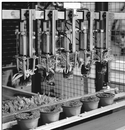
Detalje af gribearmene og omplantningsprocessen
