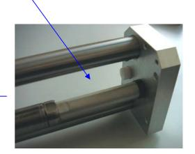
5/ Vérifier par quelques aller-retour que le slider ne frotte pas dans le stator.
