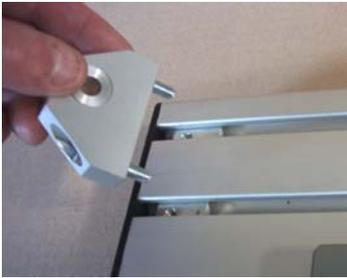
Insérer le slider par l'arrière du stator
