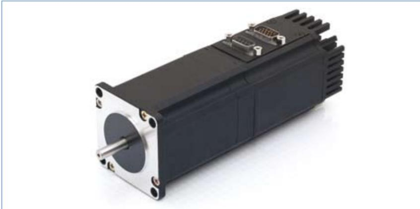
Une commande de positionnement intégrée via RS232/485 autorise un fonctionnement autonome, jusqu'à 32 moteurs en réseau. L'entrée analogique 0-10 V / 0-5 V ou +/-10 V autorise le réglage du régime avec une tension externe. L'entrée pulsée/de direction offre aussi une marche synchronisée sur des axes supérieurs.
