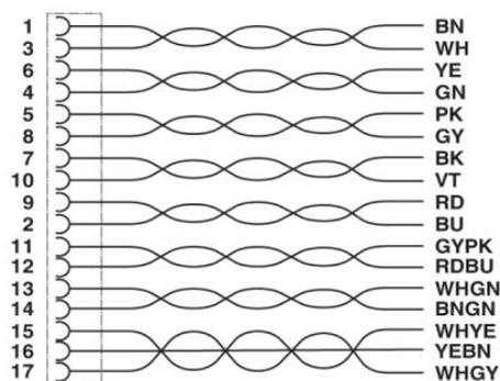
Kontaktbelegung der M12-Buchse
