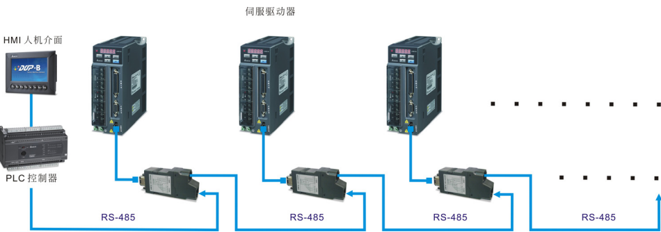
ASDA 系列伺服驱动器与 DVP 系列 PLC 和 DOP 系列 HMI 等控制器连接示意图
